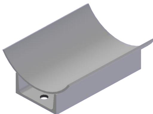
**Rohrlager auf U-Eisen mit einer Schale**
